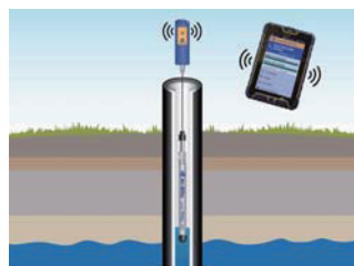
Wireless Rugged TROLL Com での通信イメージ
