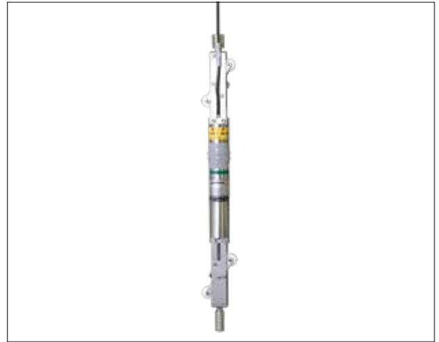
地山の変位や構造物変位の自動計測をおこなう傾斜計です。あらかじめ、専用ガイド管を地盤や構造物に設置し、ガイド管内に複数の傾斜計を測定位置にくるように中継ロッド (KBF-33) で接続し固定します。データロガー TDSシリーズとの組合せで自動計測や変位のグラフィック表示も可能です。地滑り変位測定や土留め壁の変位測定などに使用されます。測定軸数によってKB-JG型とKB-KG型を揃えて、KB-JG型は1方向測定のみ、KB-KG型は1台でX方向とY方向の2方向が同時に測定できます。アレスタ内蔵も製作可能です。
