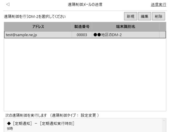
5. 設定変更の遠隔制御メールが DM-2 で正常に受信されると、その結果がレポートメールとして返ってきます。レポートメールはテキスト形式のメールのため、通常のメールソフトなどで受信してください。
