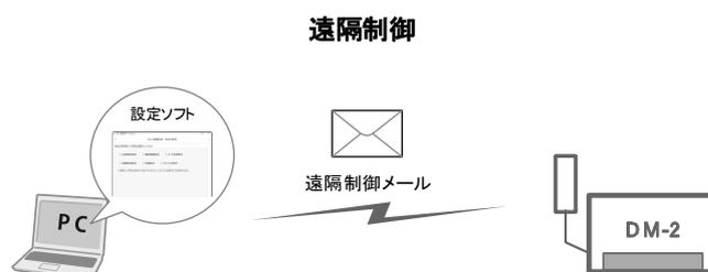
設定ソフトでは USB 接続による本器の各種設定や遠隔制御メールによる本器の遠隔制御を行うことができます。
