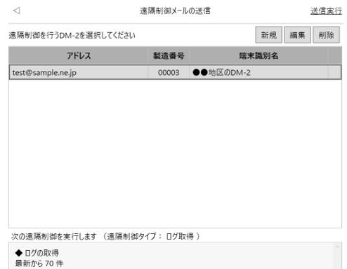
3. DM-2 が遠隔制御の処理を行い、指定されたアドレスへレポートメールを送信してきます。ログ情報については設定ソフト上で変換作業が必要となります。
