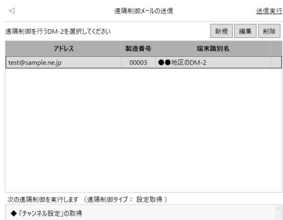
3. DM-2 が遠隔制御の処理を行い、指定されたアドレスへレポートメールを送信してきます。
