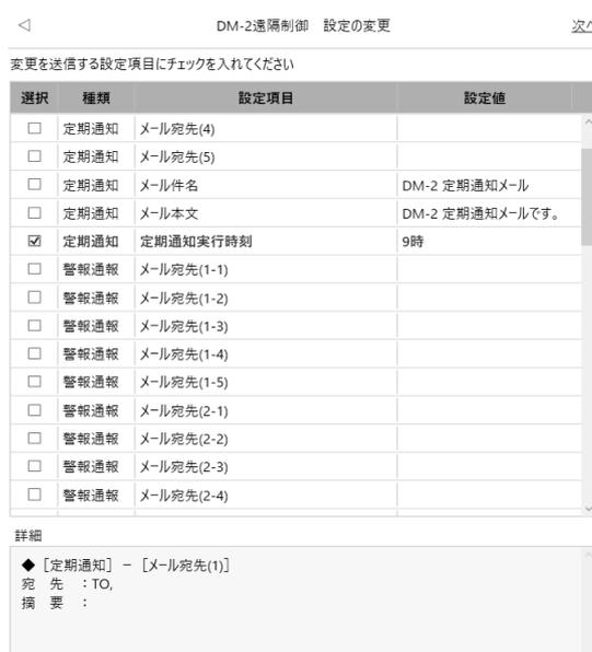
4. 遠隔制御を行う DM-2 を選択する画面が表示されるので対象となる DM-2 を選択し、「送信実行」をクリックします。
